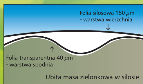
Rys.1 Zasada działania cienkiej folii transparentnej
