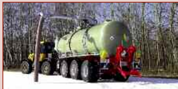
HTS 33.27 z hydraulicznym zawieszeniem trójpunktowym na różne adaptery
