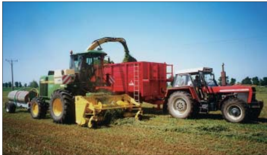
Aplikowanie BIO-SIL®'u (na podbieraczu siewczarni) oraz melasy. Melasa jest pobierana z ciągniętego za siewczarnią zbiornika i dawkowana przy jej wylocie z kanału wyrzutowego
