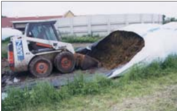
Rys. 1: Wybieranie sianokiszzonki z rękawa foliowego AG BAG
