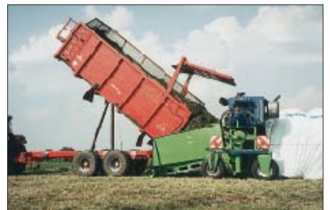
...efektywny i szybki sposób dostarczania surowca do maszyny AG BAGGER M 7000 za pomocą wywrotki firmy "Annaburger"...
