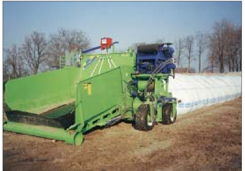
M 7000 - maszyna z własnym silnikiem o mocy od 115 do 175 PS - przeznaczona dla dużych gospodarstw.
